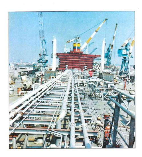
タンカーの配管 タンカーの手すり、階段 等は勿論各種送油用配管 はフランジも含め全て溶 融亜鉛めっきされた上、 塗装されています。
