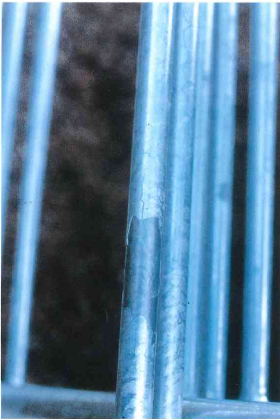
Pの影響でめっきが剥離した鋼材
