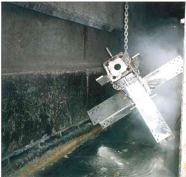
◀写真4 溶融亜鉛めっき作業中
