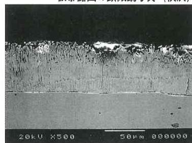
写真5 裸鋼板と接合した亜鉛めっき鋼板暴露面の顕微鏡写真（横浜）
