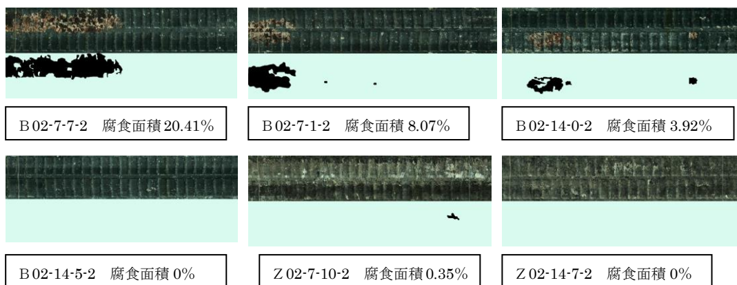
写真 2 暴露地変更伊良湖岬 9 年 3 ヶ月暴露供試体の鉄筋腐食面積測定結果
