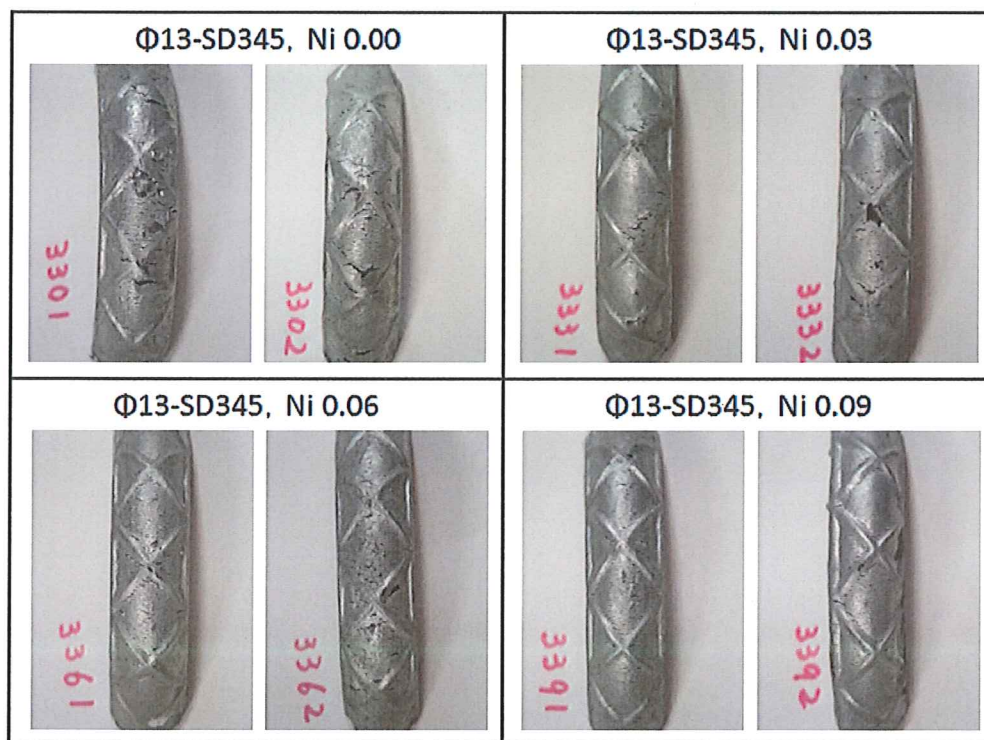
図1 φ13の各種鋼材の曲げ試験試料の外曲げ外観
