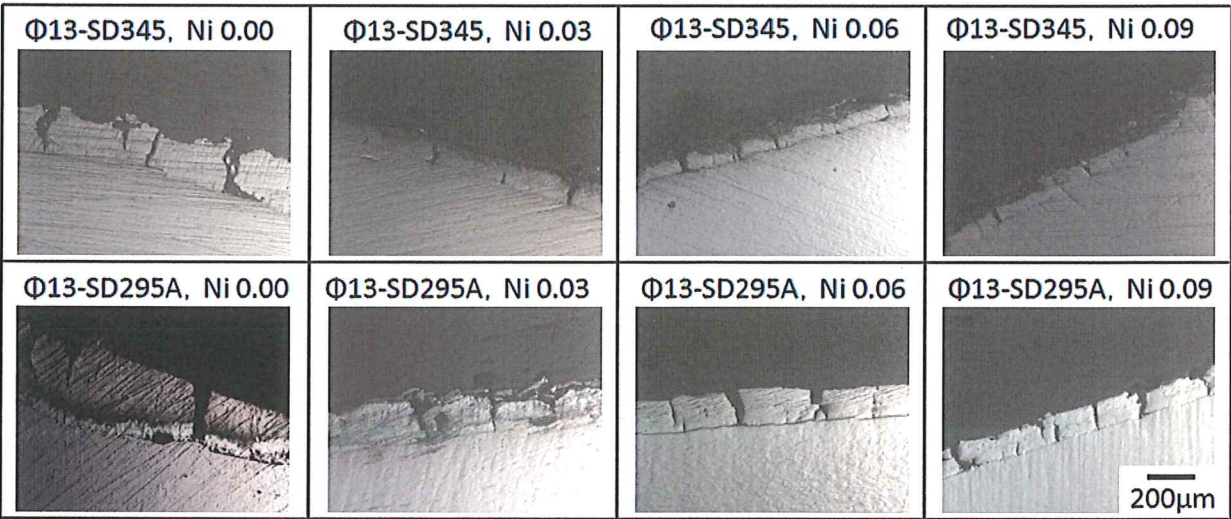
図2 φ13の各種鋼材の曲げ試験断面
