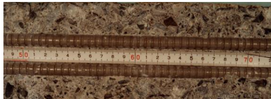
エポキシ樹脂塗装鉄筋 (200 μm)
