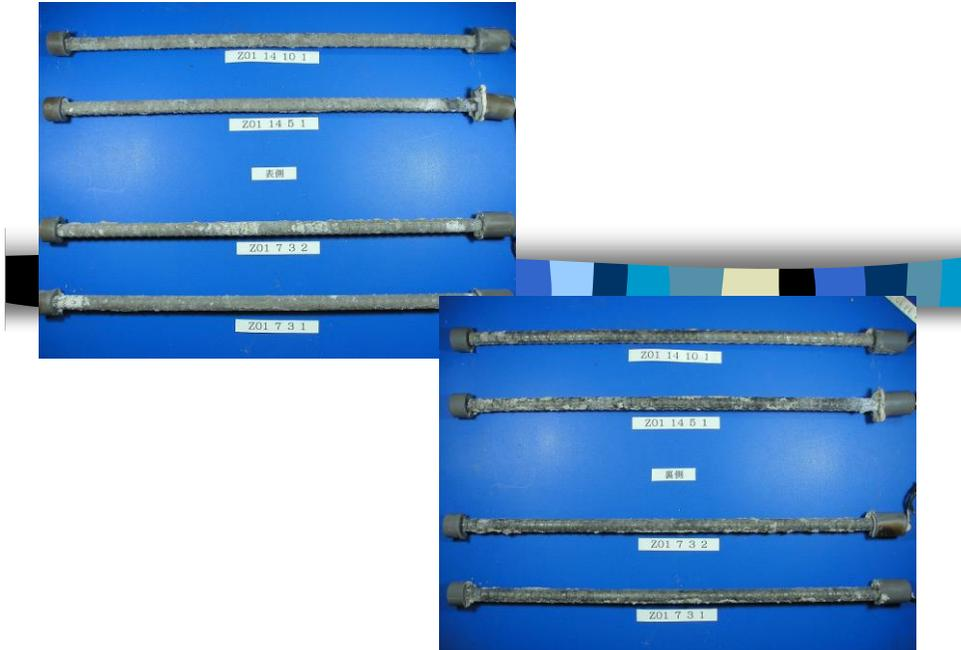
表7 福井2年7ヶ月暴露供試体の鉄筋の腐食面積
