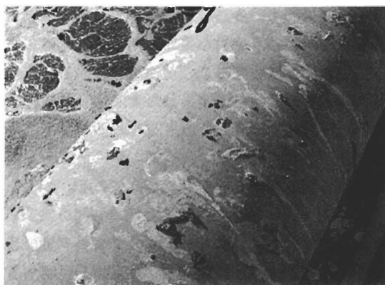
図7 ブラック・ロックにある水の再生プラントでのきびしい環境下で良好な性能を発揮している溶融亜鉛めっきした配管。
